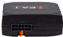
Conexão da fiação
