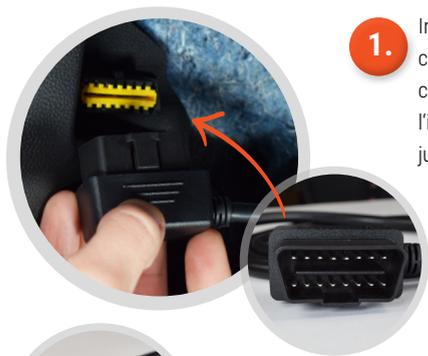
1. Insérez l'extrémité ouverte du câble d'extension, avec les broches de contact visibles, dans l'interface OBD de votre véhicule jusqu'à ce qu'elle s'enclenche.
